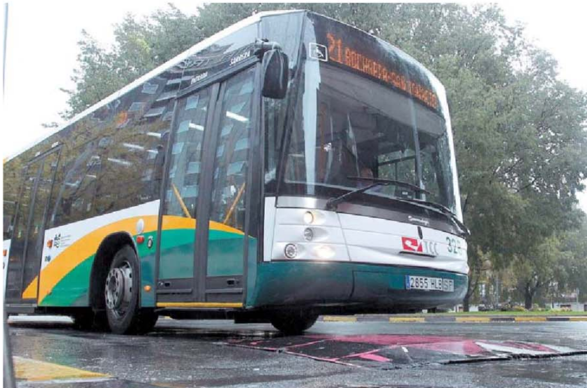
Una villavesa a punto de cruzar un 'cojín berlinés' en el centro de Pamplona. Este reductor no obliga a frenar al autobús y gana 5 segundos. CALLEJA
